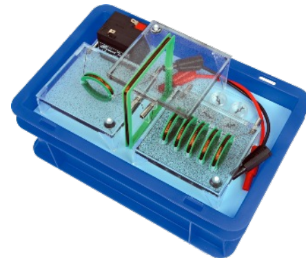
EMS 1.5. Az áramerősség és az eltérítési szög tangense közötti összefüggés
