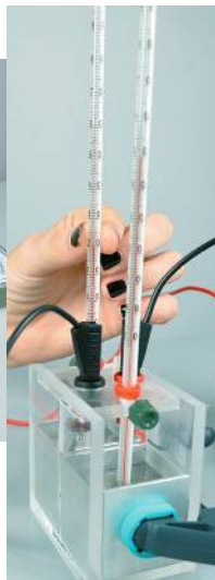
TDS 5.2. Termoelektromos hűtés, "Peltier-hatás"
